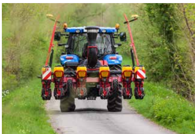
De Tempo T heeft een transportbreedte van 3,3 tot 3,5 meter. Daardoor is de draaicirkel klein en is de machine gemakkelijk te transporteren.
