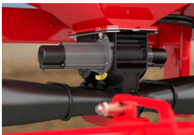
Het Fenix III-doseersysteem is ontworpen voor exact doseren, betrouwbare prestaties en gemakkelijk onderhoud.
